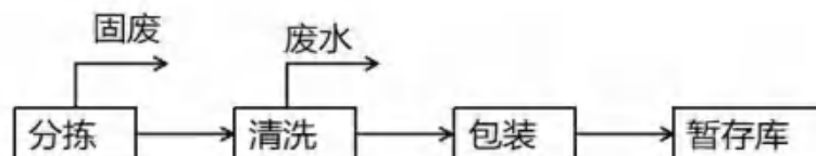
图 2-4 叶菜、根茎（净菜）类加工流程图
