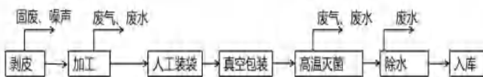
图 2-9 玉米棒加工流程图
