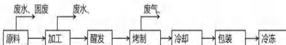
图 2-12 粽子加工流程图
